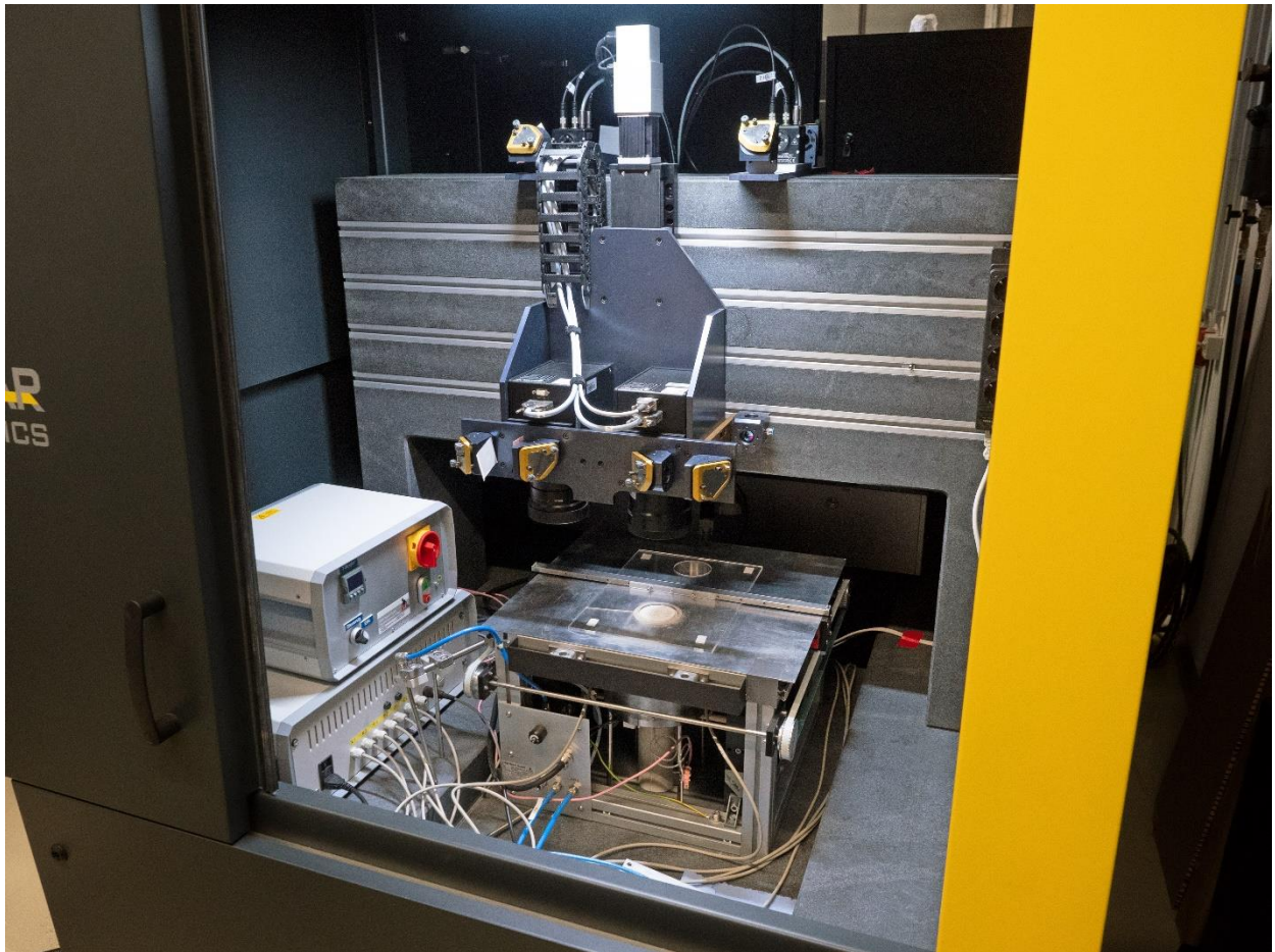
Im Rahmen von „LASERPORE“ erweiterte Lasermaschine RDX1000 zum selektiven Lasersintern (SLS) für die Herstellung poröser Glasformkörper (Quelle: EAH Jena)
