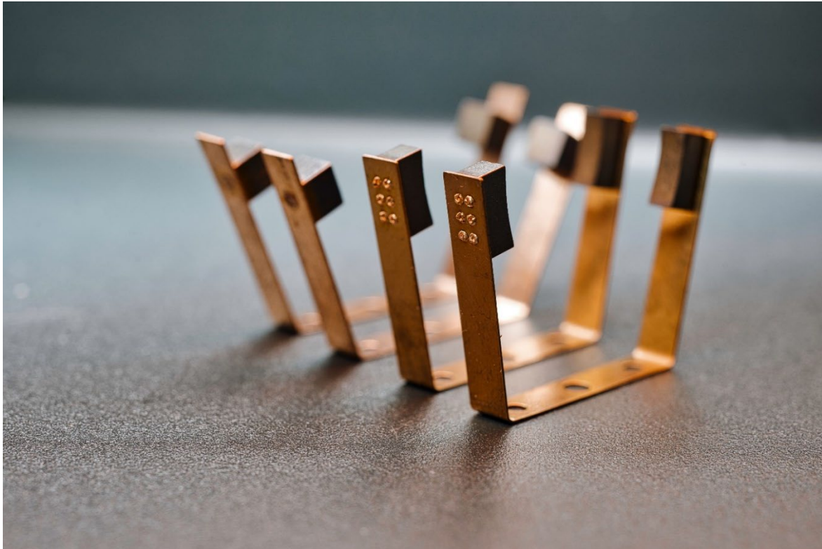
Abbildung 3: Lasergeschweißte Kohlebürsten kommen u. a. in der Automobilbranche zum Einsatz und müssen hohe Stromdichten aushalten können. Sie bilden z. B. einen Gleitkontakt in Elektromotoren sowie in Generatoren und stellen so den elektrischen Kontakt zum rotierenden Teil eines Motors, dem Kollektor oder Rotor her. ©Daniel Keller, Pulsar Photonics GmbH.
