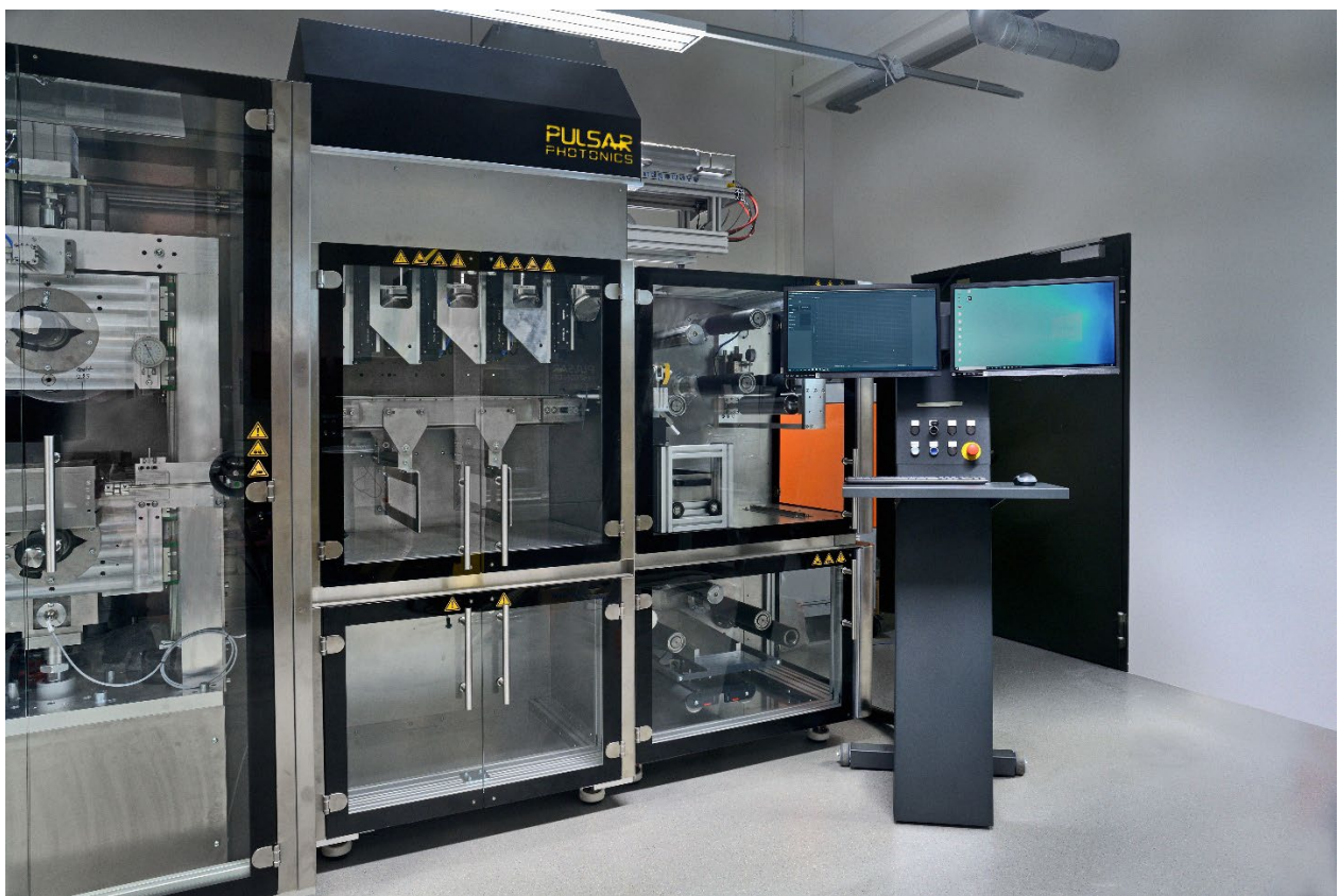
Abbildung 1: Seit 2021 werden am Fraunhofer ILT Laserprozesse für die Batteriefertigung in einem eigenen Batteriezentrum erforscht. Hier im Bild die Anlage mit der Multistrahloptik zur Laserbearbeitung. Im nächsten Schritt will Pulsar Photonics die für das NextGenBat-Projekt entwickelte Optik zur Serienreife bringen – im Idealfall mit Industriepartnern. © Fraunhofer ILT, Aachen.
