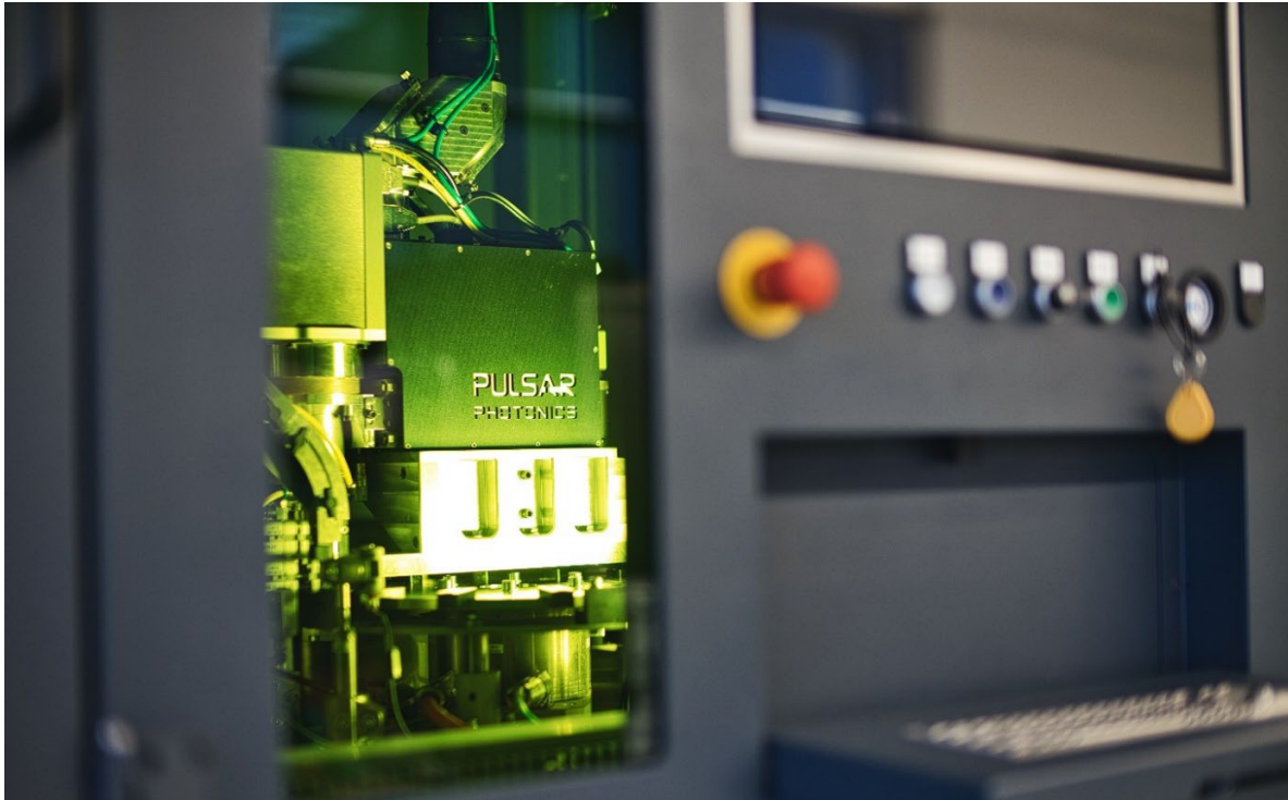
Abbildung 5: Blick in den Bearbeitungsraum mit Prozesskopf zum Laser-Mikrobohren. Die Lasermaschine P1000automatic ist mit einer integrierten 100%-Bauteilprüfung und mit einem voll-automatischem, verkettetem Bauteilhandling für die Produktion von mehr als Hunderttausend Bauteilen pro Tag ausgelegt. ©Pulsar Photonics GmbH.
