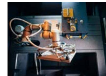
Das Maschinenbett der Anlage besteht aus Naturstein. Auf dem Bild zu sehen: Robotikeinsatz in der RDX800
