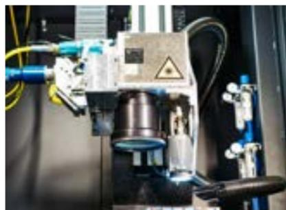
Innenansicht der RDX2Fiber mit präzisiertem Achssystem, Galvanometerscansystem und Messtechnik
