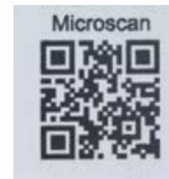
Hochauflösender QR-Code mit Abmessungen 300  $\mu\text{m}$  x 300  $\mu\text{m}$
