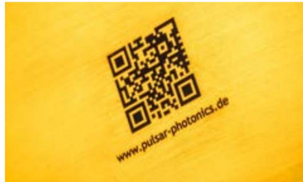
Widerstandsfähige Lasermarkierung in Stahloberfläche
