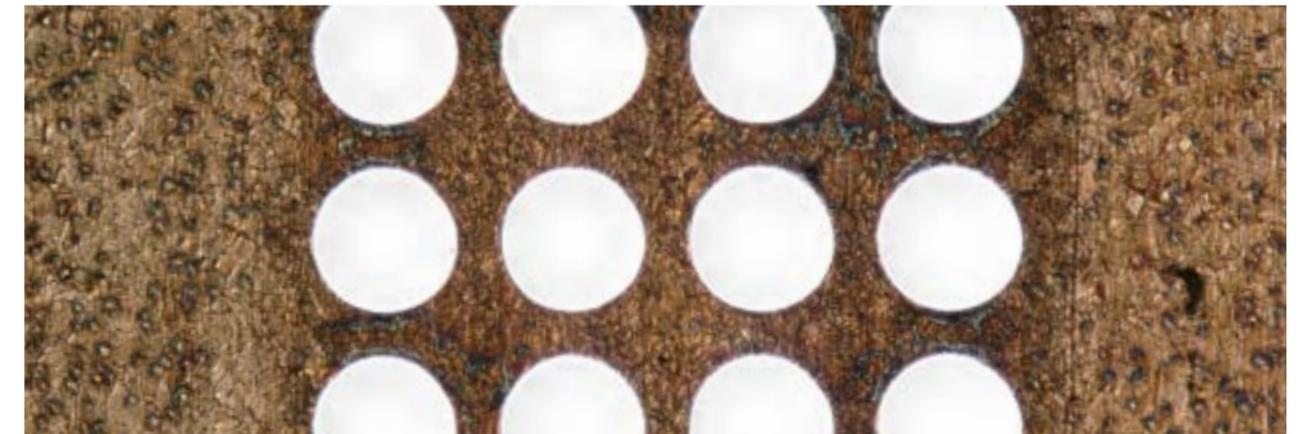
Matrix von Präzisionsbohrungen in Messing
