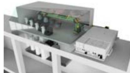
Optikmodul zur massiven Parallelisierung von Strukturierungsprozessen für Rolle-zu-Rolle-Prozesse, wobei der Laserstrahl auf vier Scannersysteme verteilt und mittels diffraktiver Elemente in Teilstrahlen aufgeteilt wird.
