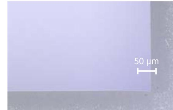
Eckiger Konturschnitt in  $Al_2O_3$  mit Kantenradius < 10 µm
