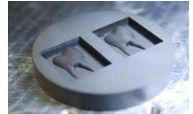
2,5D Strukturierung: Wurzel eines Zahnimplantates aus einer Hochleistungskeramik
