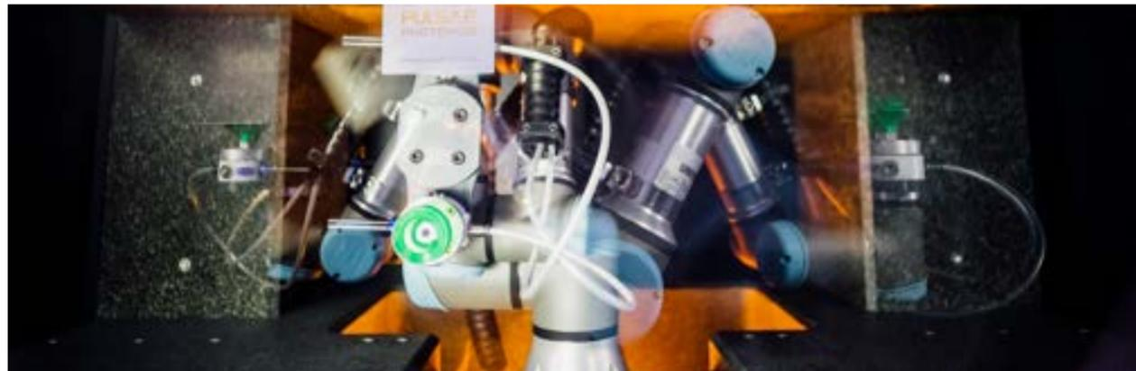
Kundenspezifische Anlage mit automatischen Werkstückmagazinen und einem integrierten UR-Roboter
