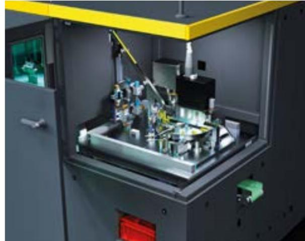
Innenraum der P1000 automatic mit Rundschalttisch und mehreren Bearbeitungs-, Handling- und Messstationen
